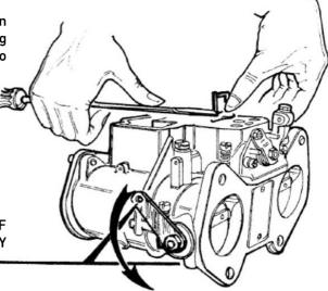
CHECK FREE SLIDING OF PUMP CONTROL SHAFT BY OPENING THROTTLES
